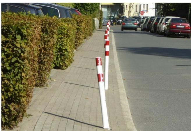
Bild 53: Gleichzeitig verengen Pfostenreihen den Gehweg.
